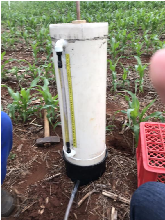
Figura 3. Teste de Infiltração de água no solo.
