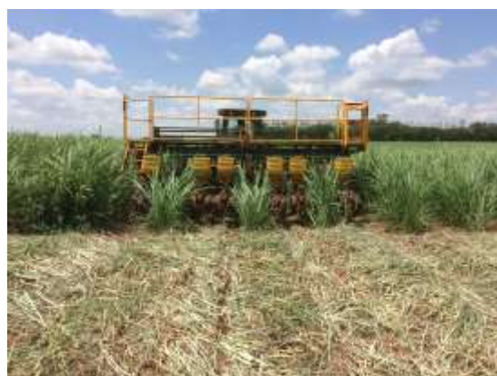
Figura 1. Configuração da semeadora COP-CA para semeadura intercalar em soqueira de cana-de-açúcar SP 80-1816. Usina COFCO Agri, Catanduva/SP, dezembro de 2017.
