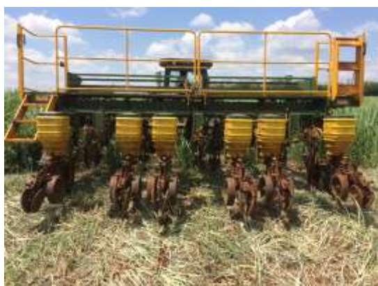
Figura 1. Configuração da semeadora COP-CA para semeadura intercalar em soqueira de cana-de-açúcar SP 80-1816. Usina COFCO Agri, Catanduva/SP, dezembro de 2017.
